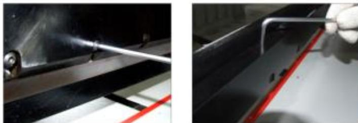
◆ Установите передний верхний винт на держателе лезвия, затем закройте крышку и зафиксируйте ее;
