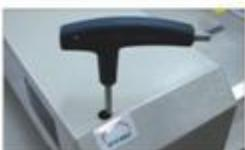
Перед началом работы протестируйте аппарат. Для этого возьмите 1 лист 80-гр. бумаги и порежьте его. Если бумага не порезана не полностью, необходимо отрегулировать глубину опускания ножа (2-3 мм).
