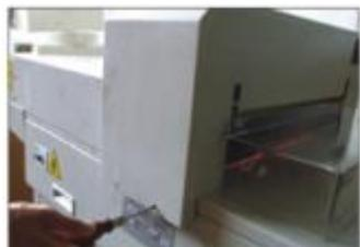
◆ Ослабьте передний верхний винт держателя лезвия, отрегулируйте винт на держателе лезвия. Как правило, наилучшая глубина положения лезвия следующая: линия резания на марзане;
